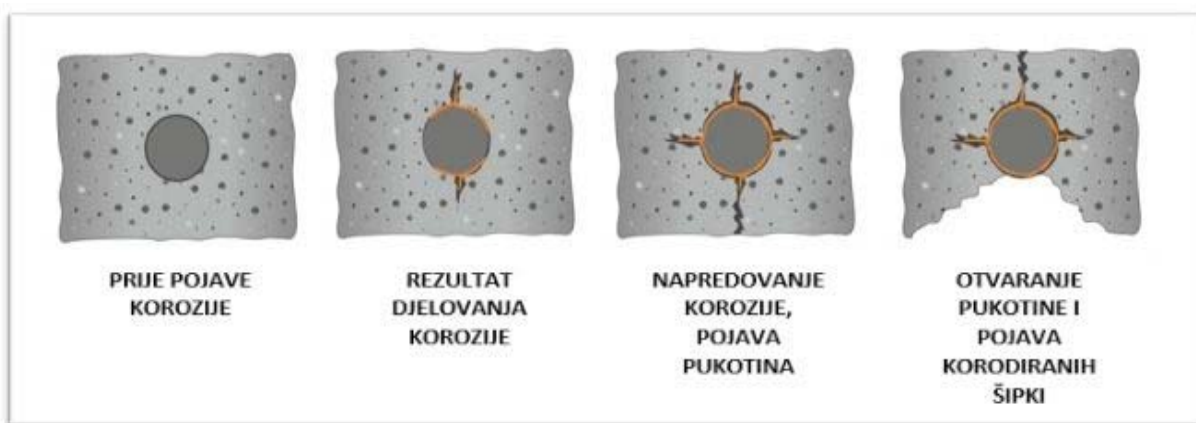
Slika 2.2. Faze procesa korozije armature
